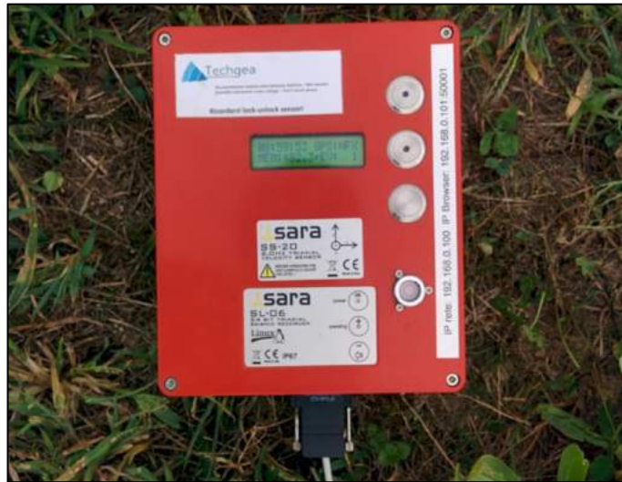
Figura 3 – Strumentazione utilizzata – Registratore sismico SL06
